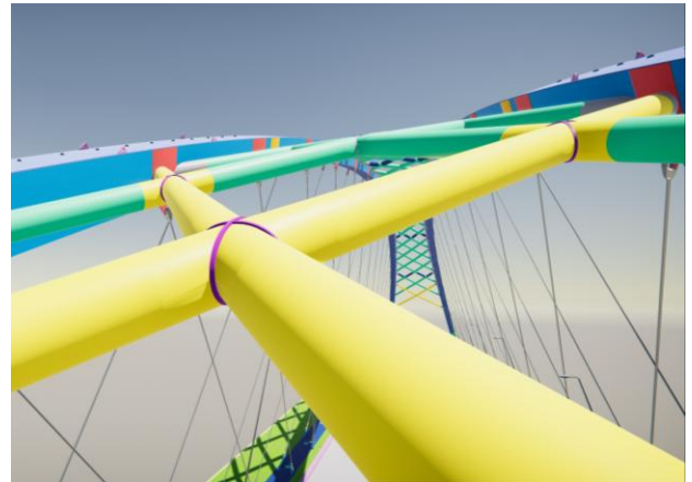
Figura 23: Intersección de vigas transversales
