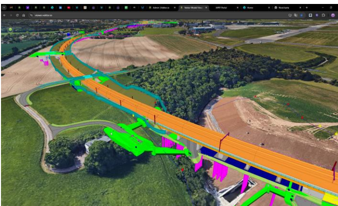
Figura 6: Visualización simultánea del modelo de vía en corte, modelo de paso elevado y ortofoto WMS de la República Checa en SW Vektor.io
